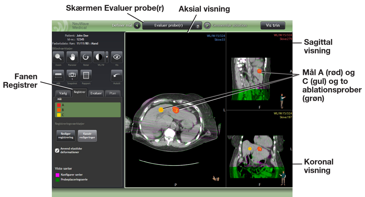
Figur 3-29: Billedserieregistrering Registrerede (overlagte) billeder af de konfigurerede CT-serier (lilla) og CT-serier med probeplacering (grøn) på skærmen Evaluer probe(r) på fanen Registrer for at bekræfte probens placering i forhold til målet.
