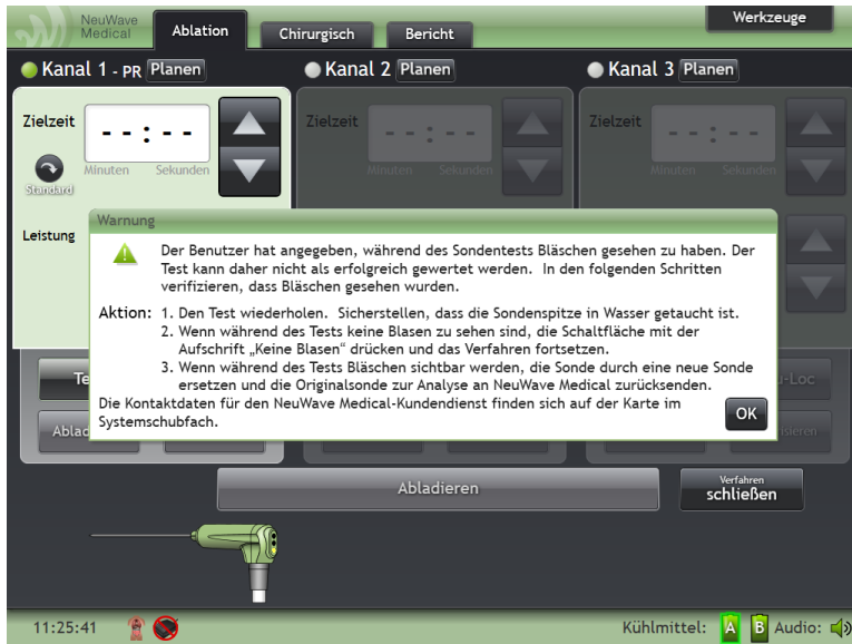
Abbildung 4-10: Wird das Flaschensymbol mit Blasen ausgewählt, so erscheint ein Fenster mit der Warnung „Sonde austauschen“.
