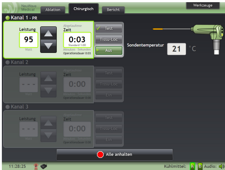
Abbildung 4-25: Registerkarte „Chirurgisch“ mit einer angeschlossenen Sonde an Kanal 1 und betätigter „Ein“-Schaltfläche
