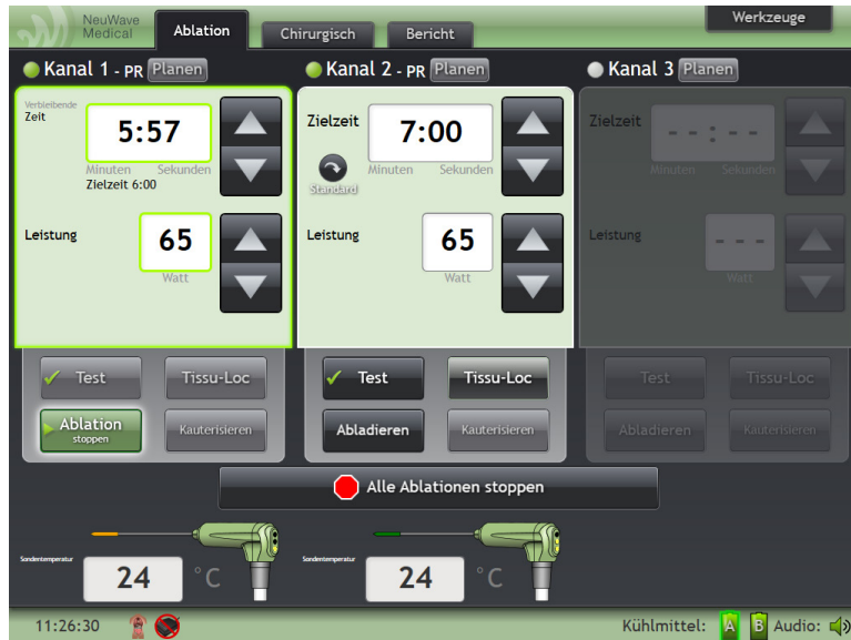
Abbildung 4-17: Kanal 1 Schaltfläche „Abladieren“ wurde gedrückt.
