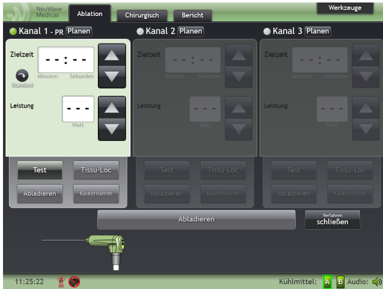
Abbildung 4-7: Registerkarte „Ablation“ nach Anschluss der Kanal-1-Sonde an das SVM.
