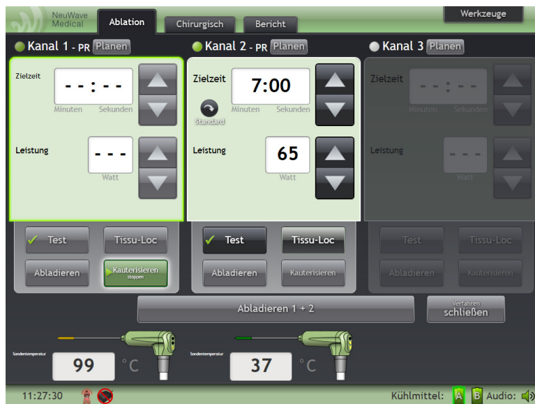
Abbildung 4-20: Registerkarte „Ablation“ mit aktiver Schaltfläche „Kauterisieren“ für Sonde an Kanal 1.
