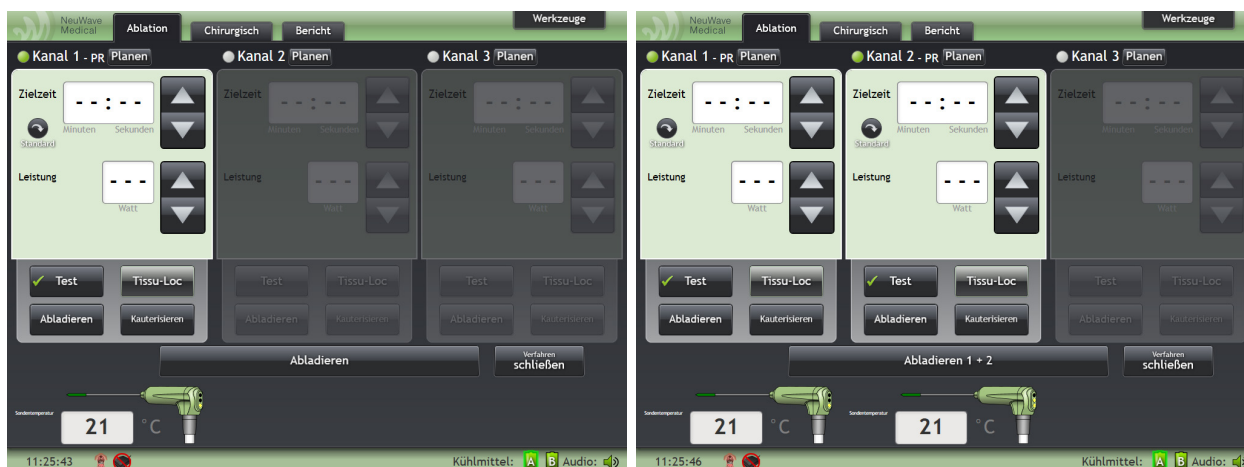
Abbildung 4-12: Registerkarte „Ablation“ mit einer angeschlossenen Sonde (links) und zwei angeschlossenen Sonden (rechts).
