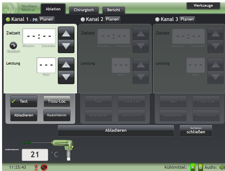
Abbildung 4-11: Registerkarte „Ablation“ mit einer Sonde an Kanal 1, die erfolgreich getestet wurde.
