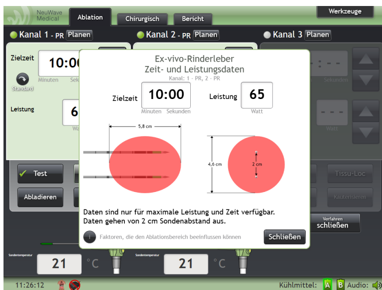
Abbildung 3-24: Beispiel eines Fensters „Visualisierung der Ablation“ für eine Ablation mit mehreren Sonden
