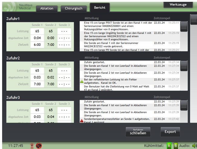
Abbildung 3-26: Registerkarte „Bericht“ mit drei Fenstern des Energiezufuhrberichts
