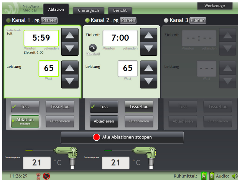
Abbildung 4-19: Kanal-1-Sonde Abladieren und Kanal-2-Sonde sind einsatzbereit, führen jedoch noch keine Energie zu.
