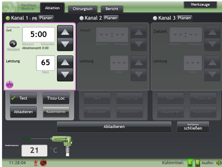
Abbildung 4-14: Bereich für die Kanaleinstellung, falls versucht wird, mit einer Sonde, die sich nicht im Gewebe befindet, Energie zuzuführen.
