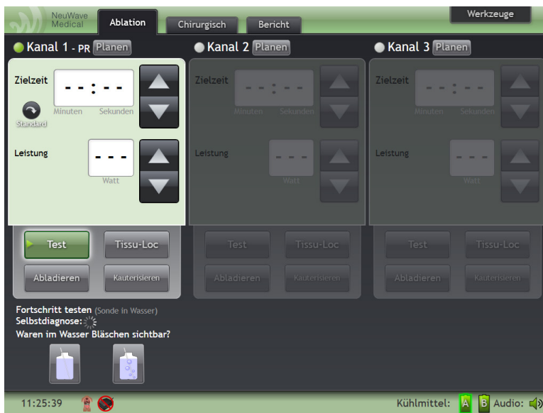
Abbildung 4-9: Sonde an Kanal 1 wird getestet (Registerkarte „Ablation“).
