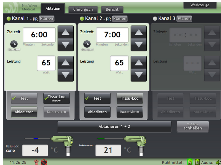
Abbildung 4-16: Die Sonde, die an Kanal 1 angeschlossen ist, befindet sich im Tissu-Loc™-Modus und die Sonde an Kanal 2 im Ruhemodus.
