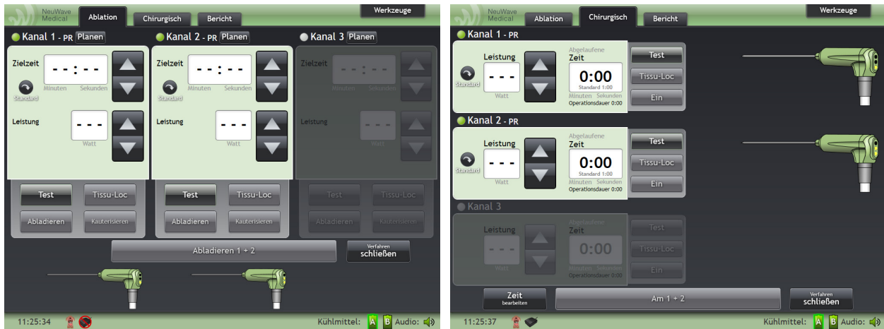
Abbildung 4-3: Erscheinungsbild der Registerkarten „Ablation“ und „Chirurgisch“, wenn mehrere Sonden angeschlossen sind. Sondenabbildungen werden für jede angeschlossene Sonde angezeigt.
