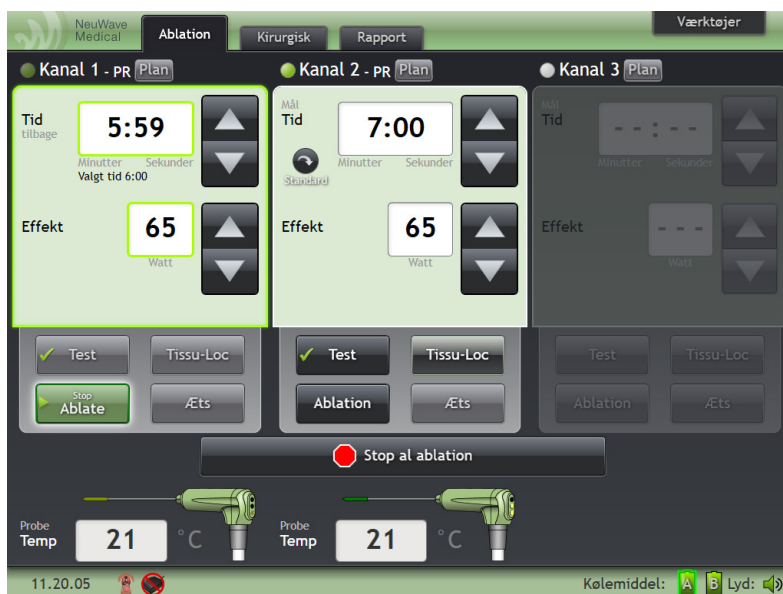
Figur 4-19: Proben for kanal 1 ablaterer, og proben for kanal 2 er klar til brug, men leverer ikke energi.
