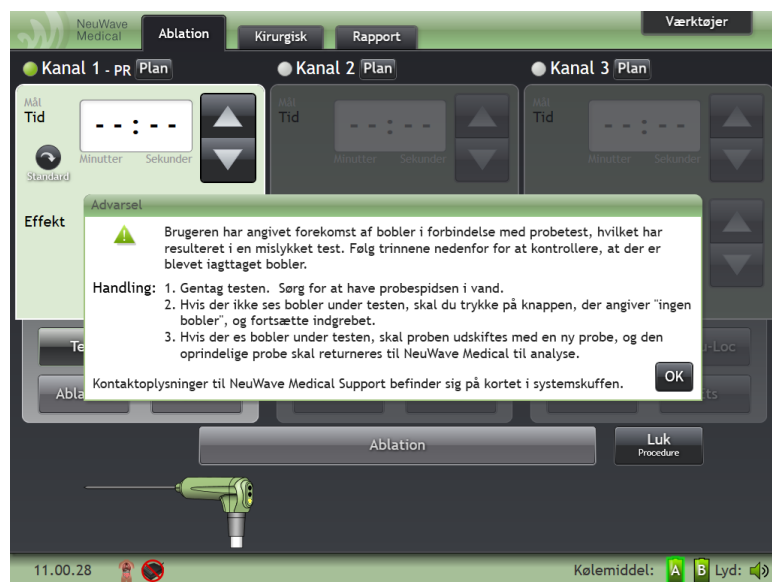
Figur 4-10: Når beholderikonet med bobler vælges, vises advarselvinduet "Udskift denne probe".
