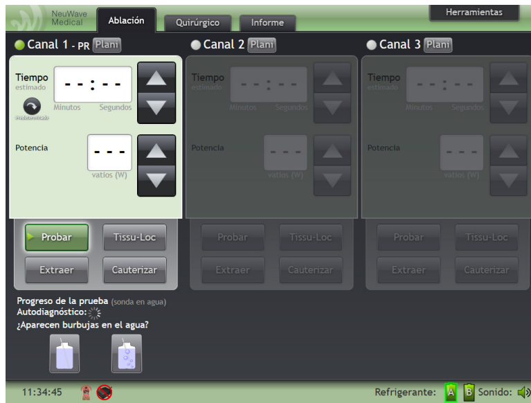
Figura 4-9: Se está probando la sonda en el canal 1 (pestaña Ablación)
