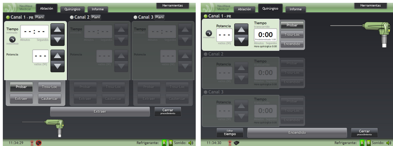
Figura 4-2: El área de configuración del canal se ilumina cuando se conecta una sonda al conector del canal correspondiente
