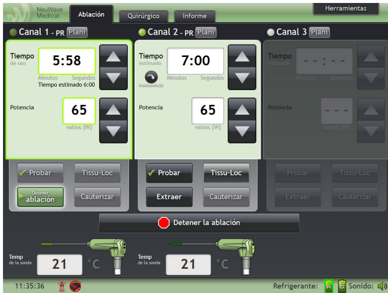
Figura 4-19: La sonda de ablación del canal 1 y la sonda de ablación del canal 2 están listas para su uso, pero no transmiten energía
