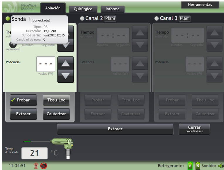
Figura 4-13: Toque el número del canal para ver la información de identificación de la sonda
