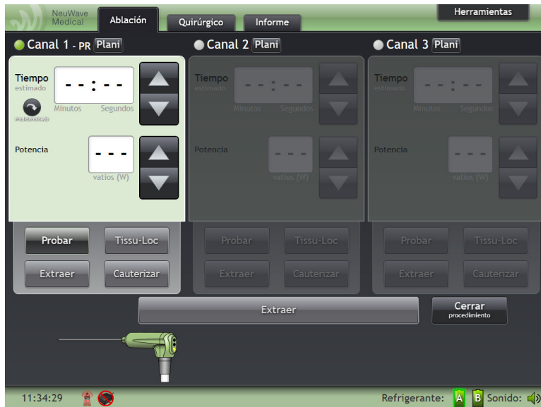
Figura 4-7: Pestaña Ablación después de conectar la sonda del canal 1 al PDM
