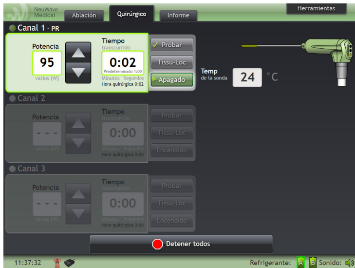
Figura 4-25: Pestaña Quirúrgico con 1 sonda conectada en el canal 1 y el botón Encendido pulsado
