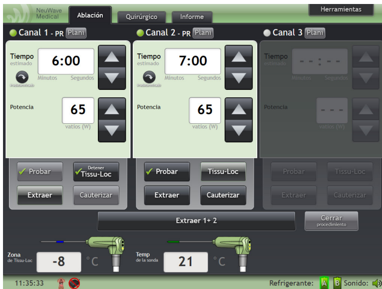
Figura 4-16: La sonda conectada al canal 1 se encuentra en Tissu-Loc™ y la sonda conectada al canal 2 está inactiva
