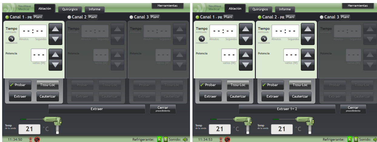
Figura 4-12: Pestaña Ablación con una sonda conectada (izquierda) y con dos sondas conectadas (derecha)
