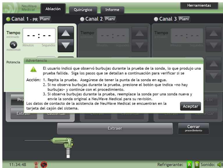
Figura 4-10: Cuando selecciona el icono del frasco con burbujas, aparece una ventana de advertencia con la leyenda “Reemplace esta sonda”
