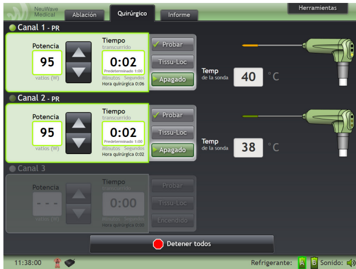
Figura 4-26: Pestaña Quirúrgico con dos sondas conectadas y la barra de control pulsada
