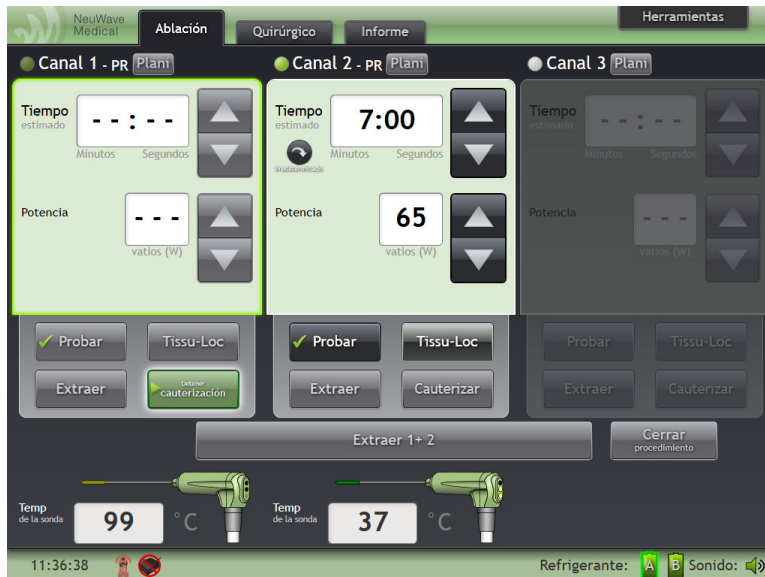
Figura 4-20: Pestaña Ablación con el botón Cauterizar en uso de la sonda del canal 1
