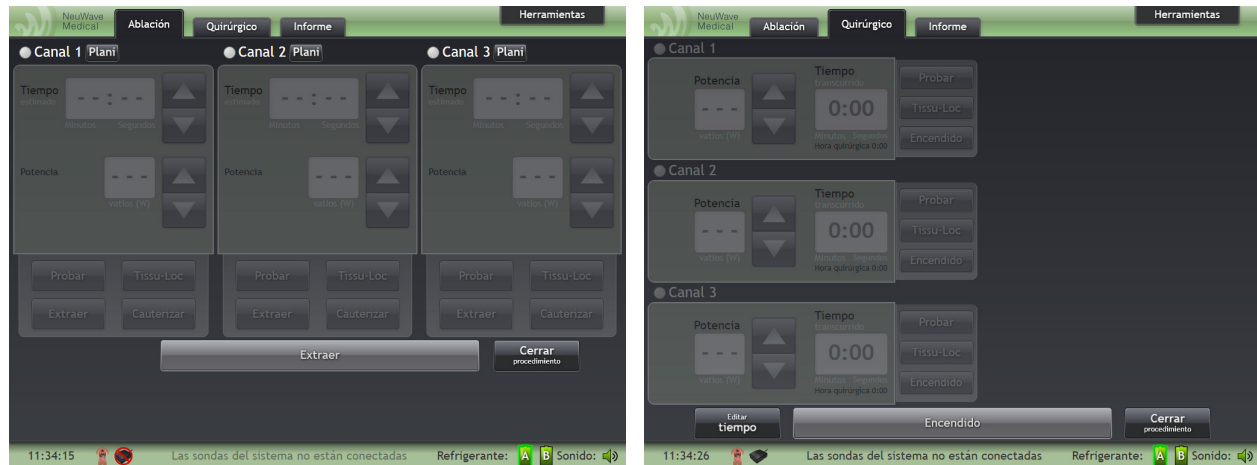
Figura 4-1: Aspecto de las pestañas Ablación a la izquierda y Quirúrgico a la derecha cuando no hay ninguna sonda conectada al sistema. Los controles aparecen sombreados en gris cuando están inactivos
