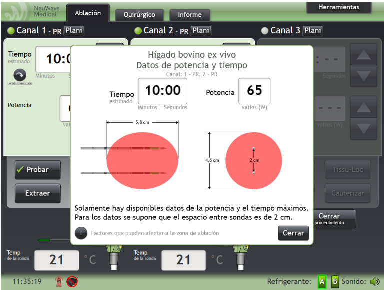
Figura 3-24: Ejemplo de ventana de visualización de la ablación para múltiples sondas de ablación
