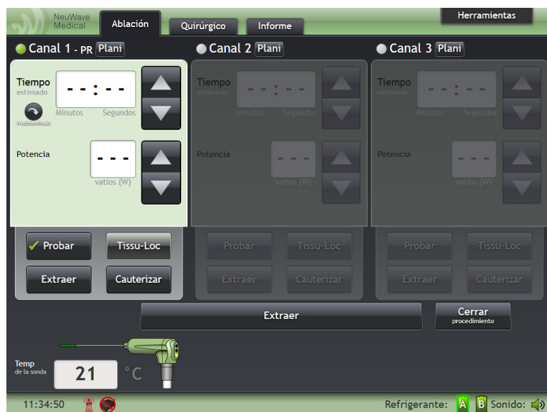
Figura 4-11: Pestaña Ablación con sonda en el canal 1 que pasó la prueba correctamente
