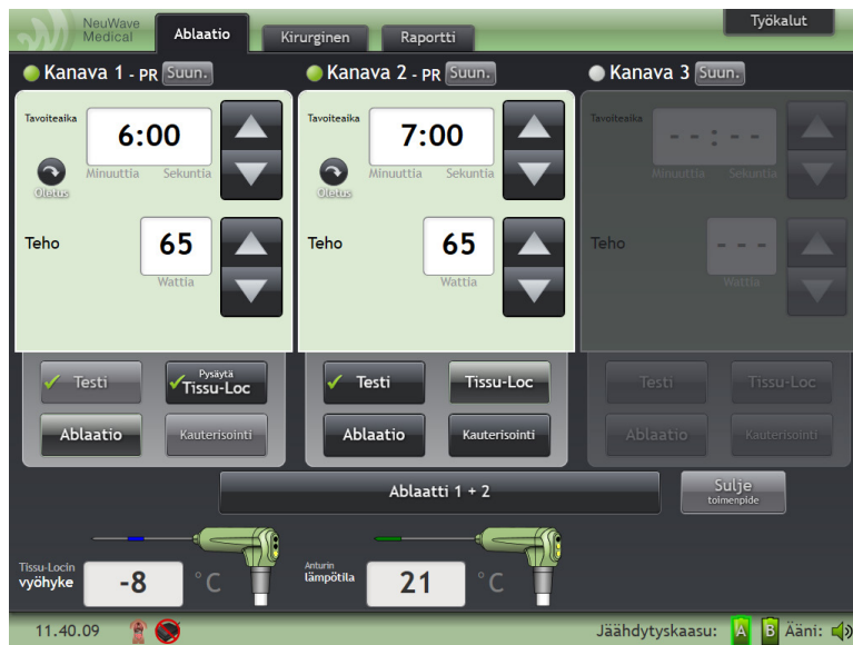
Kuva 4-16: Kanavaan 1 liitetty anturi on Tissu-Loc™-toiminnossa ja kanavaan 2 liitetty anturi toimettomana
