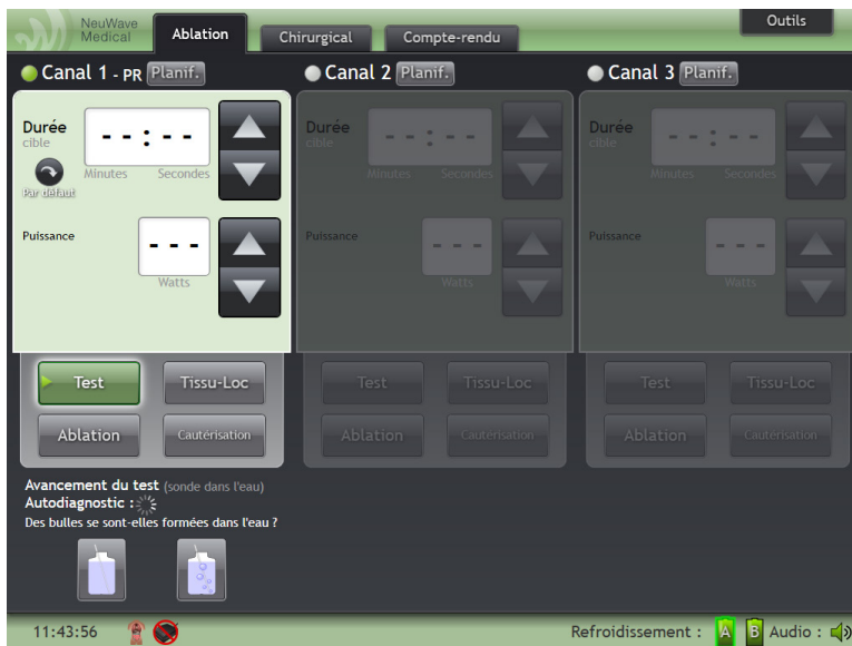
Figure 4-9 : La sonde du canal 1 est en cours de test (onglet « Ablation »).
