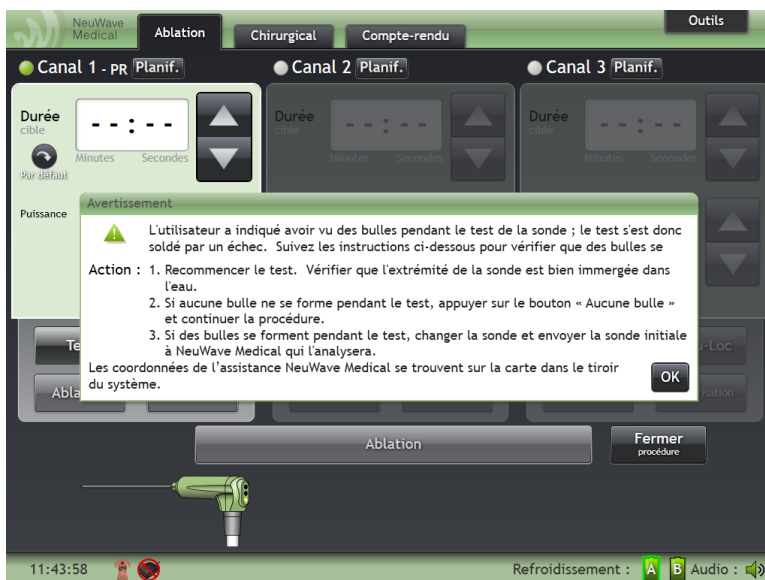
Figure 4-10 : Lorsque l'on sélectionne l'icône du flacon comportant des bulles, une fenêtre d'avertissement pour « changer la sonde » s'affiche à l'écran.
