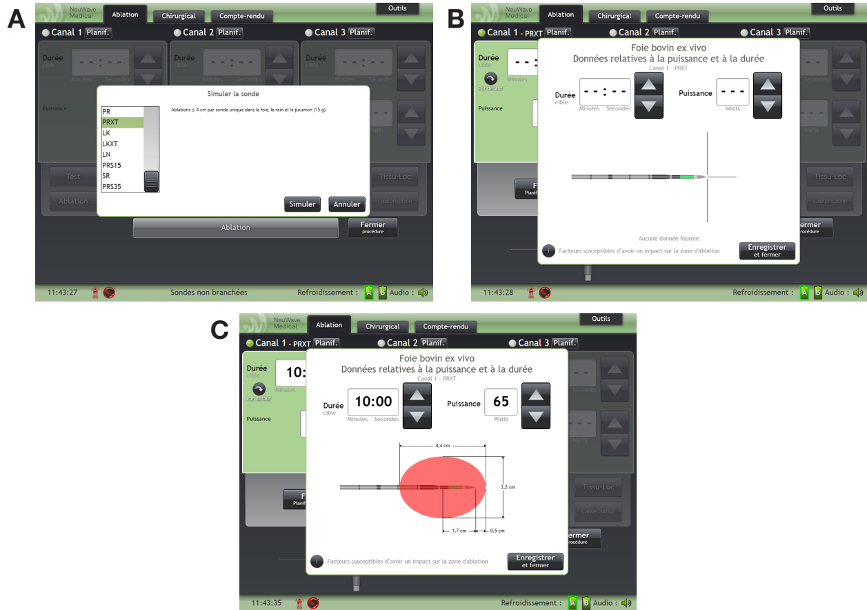
Figure 3-22 : A, B et C montrent les écrans de planification d'une simulation logicielle pour projeter les dimensions de la zone d'ablation en utilisant une sonde PRXT à 65 W pendant 10 minutes.
