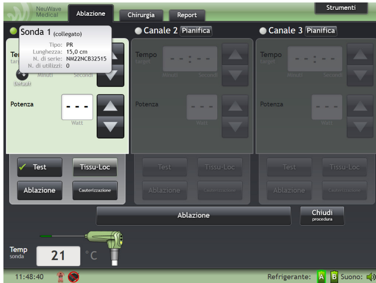
Figura 4-13: Toccare il numero del canale per visualizzare le informazioni di identificazione della sonda.
