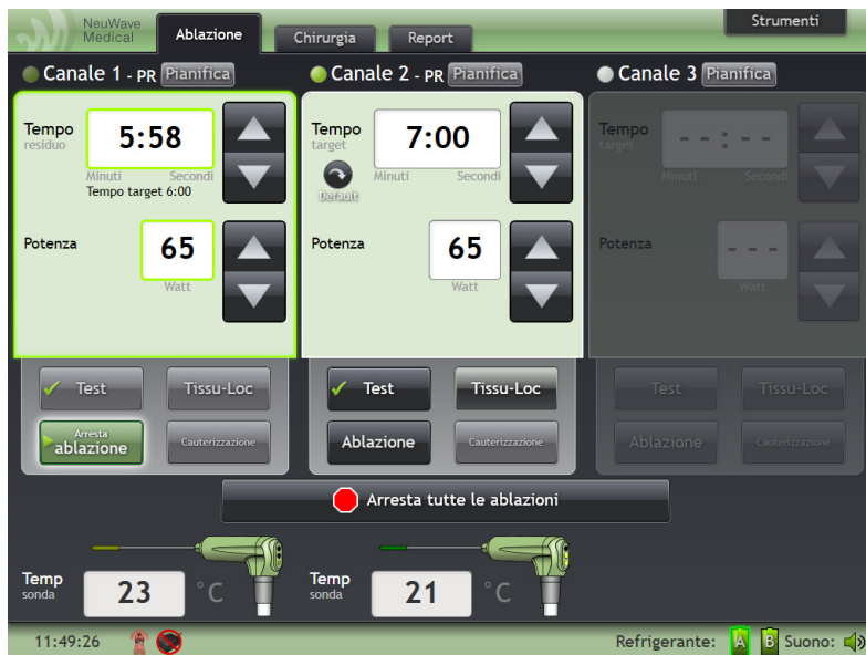
Figura 4-19: Sonda del canale 1 in fase di ablazione e sonda del canale 2 pronta per l'uso, senza erogazione di energia.
