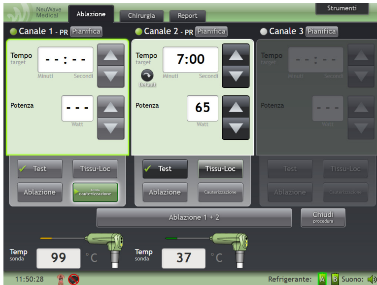
Figura 4-20: Scheda Ablazione con pulsante Cauterizzazione in uso per la sonda del canale 1.
