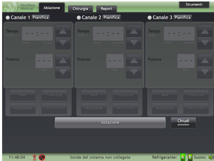
Figura 3-21: Schermata Canali di ablazione/Pianificazione dell'ablazione.
