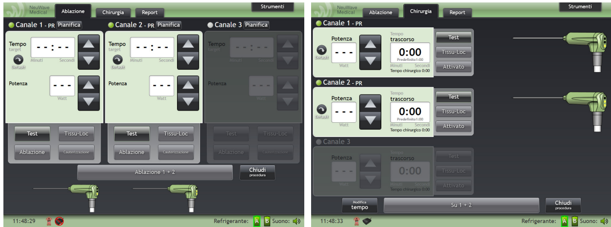
Figura 4-3: Aspetto delle schede Ablazione e Chirurgia quando sono collegate più sonde. Per ogni sonda collegata vengono visualizzate le immagini della sonda.
