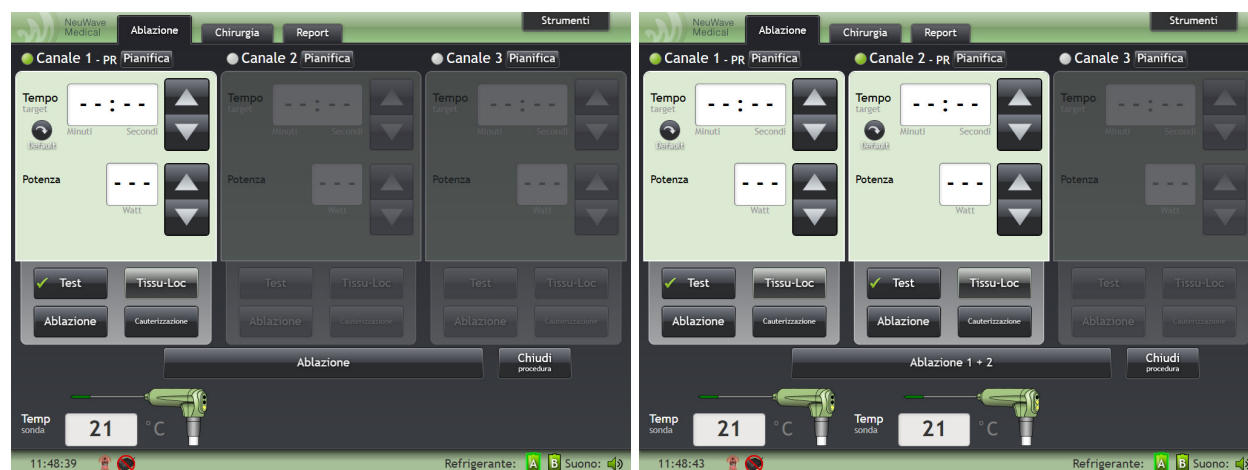
Figura 4-12: Scheda Ablazione con una sonda collegata (a sinistra) e con due sonde collegate (a destra)
