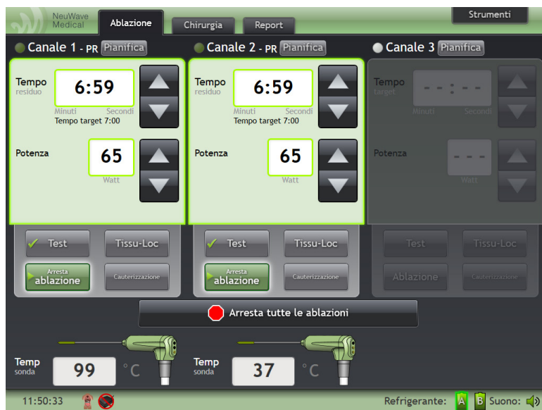
Figura 4-18: È stata premuta la barra Ablazione dei canali 1 e 2.
