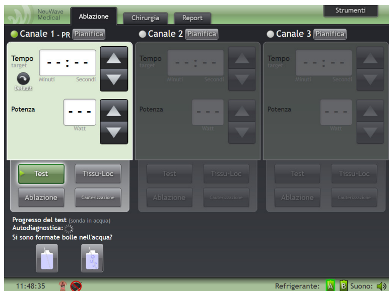
Figura 4-9: La sonda del canale 1 è in fase di test (scheda Ablazione).
