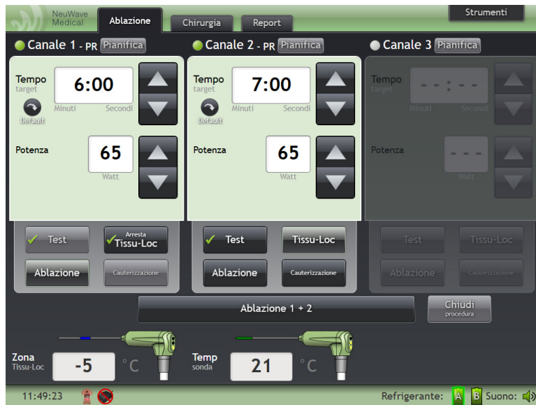
Figura 4-16: La sonda collegata al canale 1 si trova in Tissu-Loc™ e la sonda collegata al canale 2 è inattiva.
