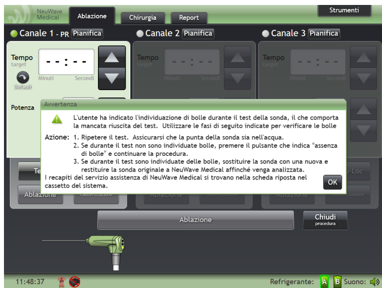
Figura 4-10: Quando viene selezionata l'icona del flacone con le bolle, viene visualizzata una finestra di avvertenza "Sostituire la sonda".
