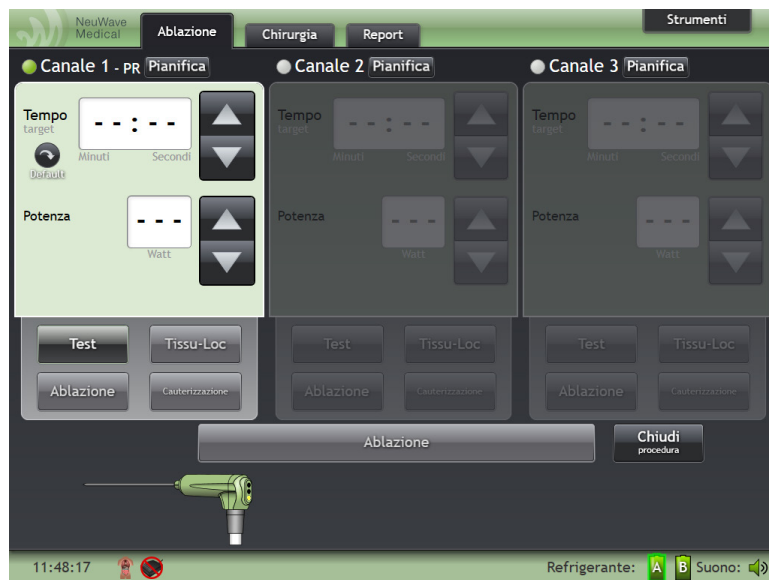
Figura 4-7: Scheda Ablazione dopo il collegamento della sonda del canale 1 al PDM.
