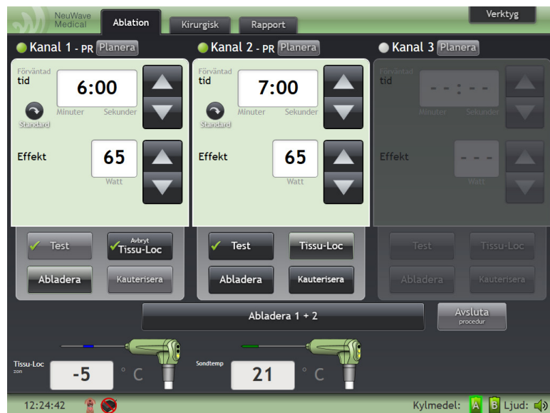
Bild 4-16: Sonden som är ansluten till Kanal 1 är i Tissu-Loc™ och sonden som är ansluten till Kanal 2 är inaktiv.
