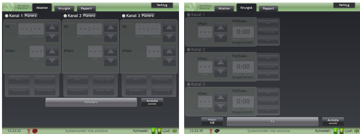
Bild 4-1: Utseendet på flikarna Ablation (vänster) och Kirurgi (höger) när ingen sond är ansluten till systemet. Reglagen är skuggade i grått när de är inaktiva.
