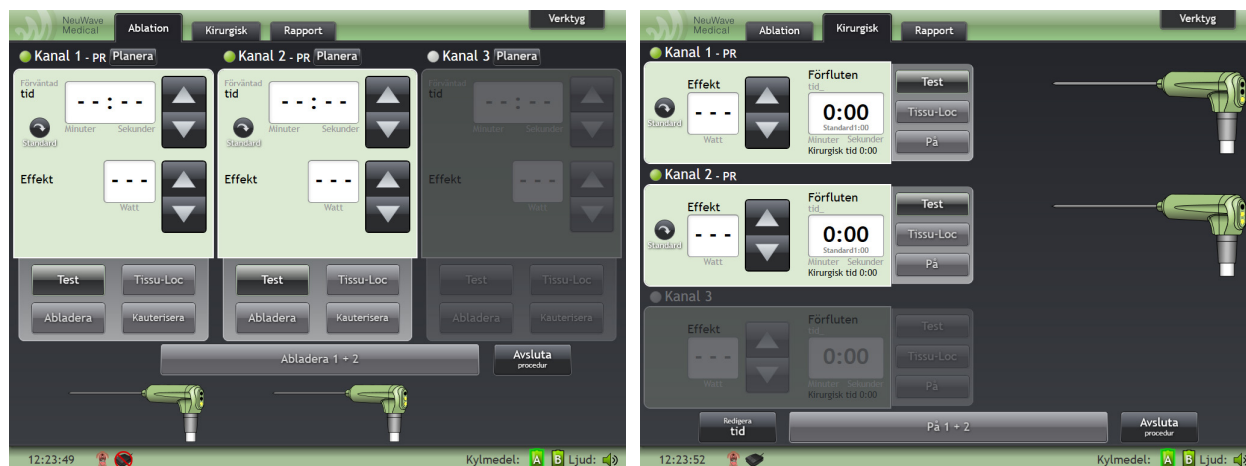
Bild 4-3: Utseendet på flikarna Ablation och Kirurgi när flera sonder är anslutna. Sombilder visas för varje ansluten sond.
